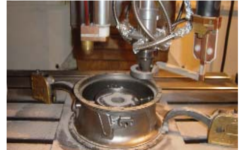
Abb. 1: 3-Achs-Fräsmaschine, Beispiel: Laser-Beschichtung eines Triebwerkflansches mit Induktionsunterstützung
