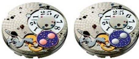
Abb. 3: Die zwei Uhrwerke der GROSSEN LANGE 1 "Luna Mundi", deren Mondscheiben am IWS beschichtet und strukturiert wurden
