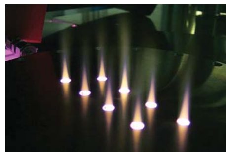
Abb. 3: Homogene Plasmagasextraktion über ein Düsenfeld bei Atmosphärendruck
