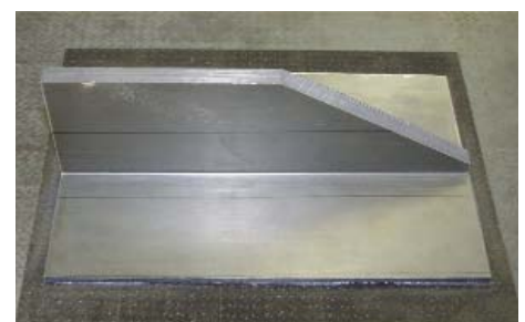
Abb. 2: Laserstrahlenschutzsystem und anschließend geklebte Stringer-Verbindung aus kohlefaserverstärktem Kunststoff
