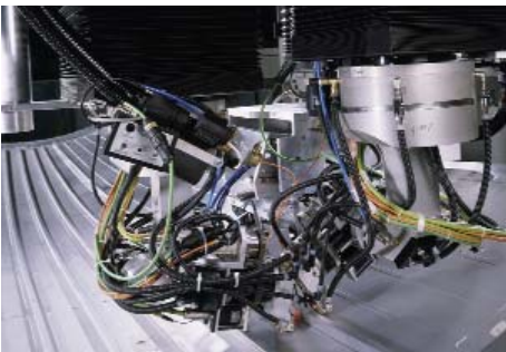
Abb. 2: Beidseitig-gleichzeitiges Schweißen von Stringer-Hautfeld-Verbindungen
