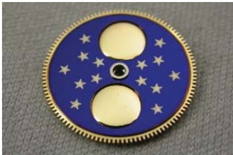
Abb. 2: Mondscheibe nach der Laserstrukturierung
