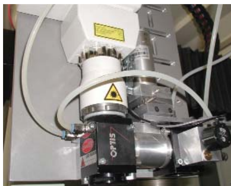
Abb. 1: Modulares Scanningsystem an 4 kW-Hochleistungsdiodenlaser
