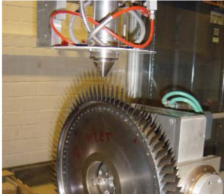
Abb. 1: Schweißaufbau zur Instandsetzung beschädigter Titan-Blisks durch Laserstrahl-Auftragschweißen
