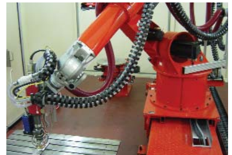
Abb. 2: Reis-Roboter, direkt angebaute 4 kW-Diodenlaser, Optik mit Prozessüberwachung und Koaxialdüse
