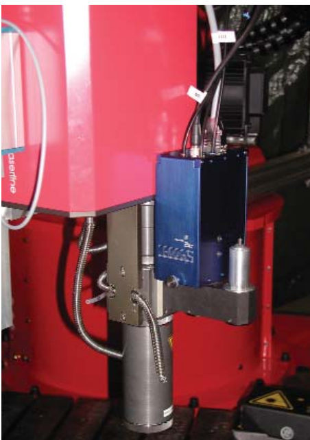
Abb. 1: Temperaturerfassungssystem angeflanscht an die Optik eines Hochleistungsdiodenlasers, koaxiale Prozessbeobachtung
