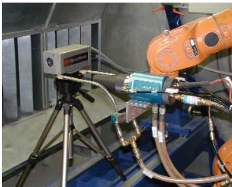
Abb. 1: An das Handhabungssystem montierter HVOF-Brenner und On-line-Diagnosesystem
