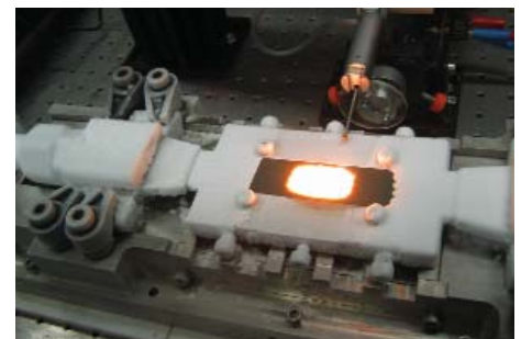
Abb. 3: Fotoaufnahme eines Prüflings während der Heizphase eines Thermozyklertests
