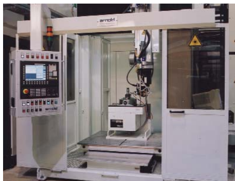
Laserstrahlschweißanlage mit 6 kW-CO 2 -Hochleistungslaser
