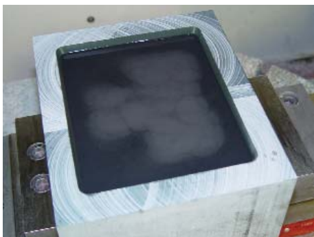
Abb. 1: Patentierte Prozesskette pcPro ® : - 3D-CAD-Datenbearbeitung - Fräsen einer Werkzeughälfte - Ausgießen der Werkzeughälfte - Fräsen der Innenkontur - Entformen (nicht dargestellt)
