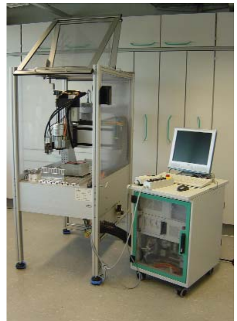
Abb. 3: pcPro®-Anlage zum Gießen und Fräsen von Kunststoffteilen
