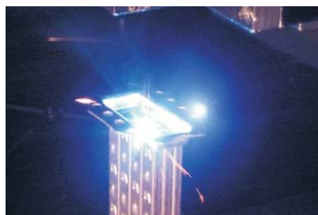
Schweißen der Rohr-Boden-Verbindung am Abgaswärmetauscher unter Nutzung einer Strahlablenkoptik
