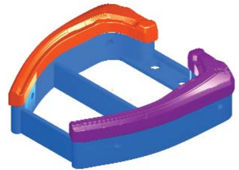
Abb. 4: CAD-Modell des Doppelstempels zum Tiefziehen von Karosserieteilen
