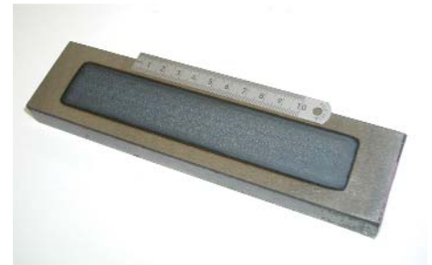
Abb. 2: Härtezone auf C45, 27 mm breit, gehärtet mit 2,5 kW-Hochleistungsdiodenlaser und Scanningsystem
