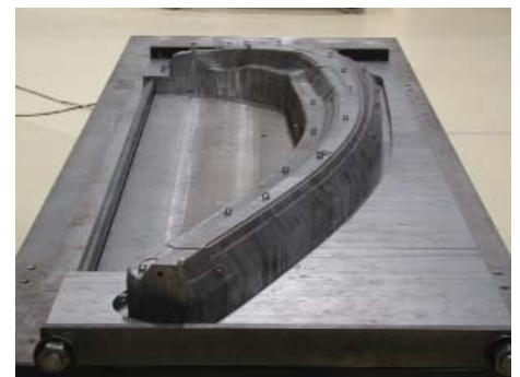
Abb. 5: Teilstück des Doppelstempels in MELATO®-Bauweise
