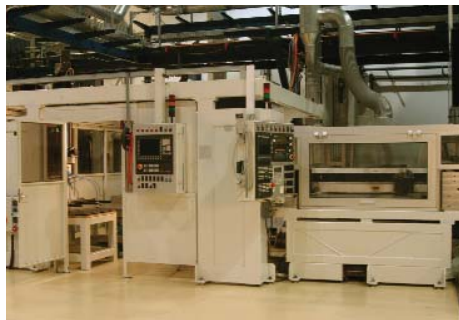
Abb. 1: Laserstrahl-Schneidmaschine (rechts) mit Handhabungssystem (links)
