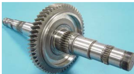
Abb. 3: Antriebswelle eines Radlader-Getriebes aus 42CrMo4
