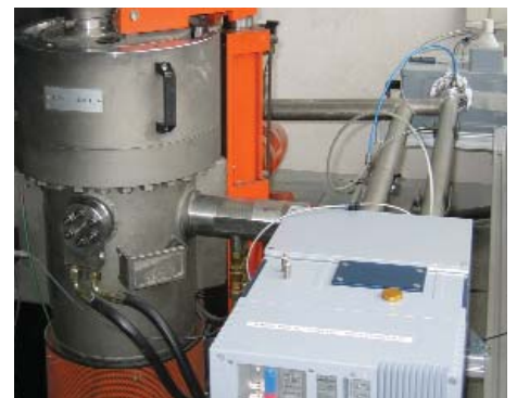
Abb. 2: FTIR-spektroskopische Untersuchungen an einem industriellen Sinterofen zur Herstellung von Keramik-Formteilen
