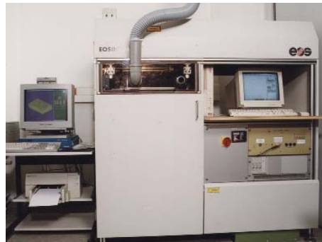
Anlage zum Rapid-Prototyping durch direktes Laser-Flüssigphasen-Sintern
