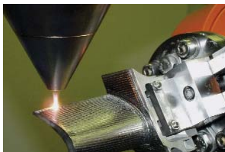
Reparatur von Gasturbinenschaufeln durch Auftragschweißen mit Hochleistungs-Diodenlaser
