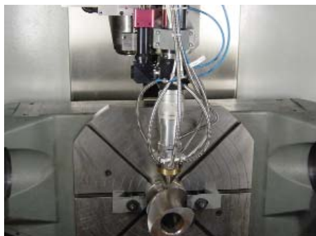
Abb. 3: Komponenten zum geregelten Laser-auftragschweißen an Hermle C800
