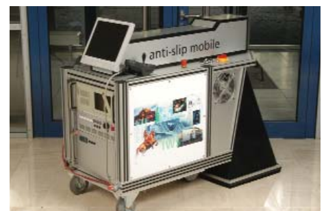
Mobile Anlage zur rutschhemmenden Aus- rüstung von Natursteinen
