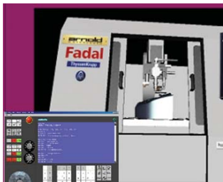
Abb. 1: Darstellung des zweistufigen Simulationsvorganges aus virtuellem Eingabegerät und virtueller Bearbeitungssituation
